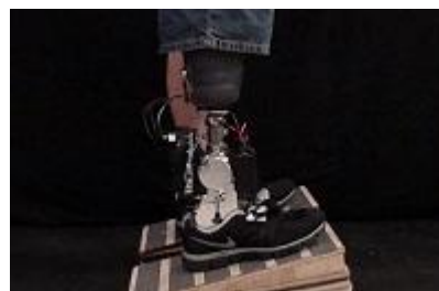
Robotinis kojos protezas skirtas tiems, kam koja amputuota ties blauzdos viduriu.
